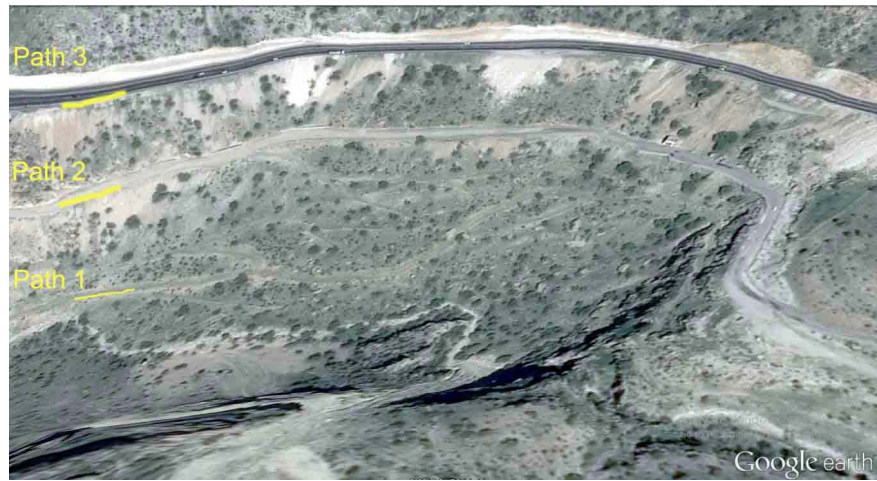
► تصویر ۹. نمای هوایی از سه مرحله‌ی راه‌سازی در نیمه‌ی پایینی گردنه‌ی پاتاق (WWW. Googleearth.Com).
