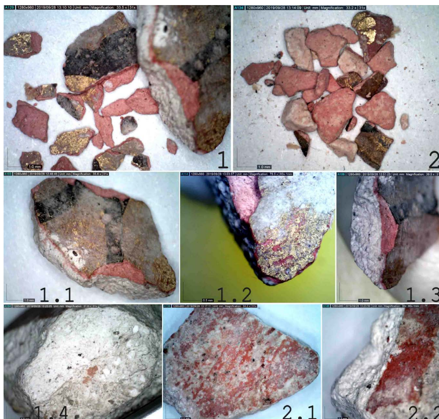
تصویر ۴. تصاویر ماکروسکوپی از نمونه‌های آرایه‌ی لایه‌چینی و طلاکاری دوره‌های صفوی عمارت چهل‌ستون قزوین؛ تصاویر ۱ تا ۱،۴ مربوط به دوره‌ی اول که لایه‌های طلا، لایه‌ی قرمز، بستر و آستر را نشان می‌دهد؛ تصاویر ۲ تا ۲،۲ مربوط به دوره‌ی دوم که لایه‌های طلا، لایه‌ی قرمز و بستر را نشان می‌دهد (نگارندگان، ۱۳۹۸). ◀
