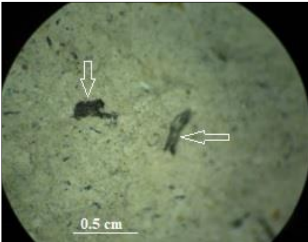
▲ شکل ۱۲. تصاویر میکروسکوپی ملات گچ‌بری راهروی طبقه اول، ذرات خاکستر در تصویر سمت راست مشخص شده است (نگارندگان، ۱۳۹۹).
